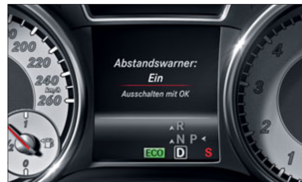
Το σύστημα COLLISION PREVENTION ASSIST μπορεί να προειδοποιεί οπτικά και ηχητικά τον οδηγό εάν η απόσταση ασφαλείας είναι πολύ μικρή.
