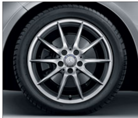
Ζάντα αλουμινίου σχεδίασης 10 ακτίνων με ελαστικά 205/50 R 17 (προαιρετικός χειμερινός τροχός, Code 25R).
