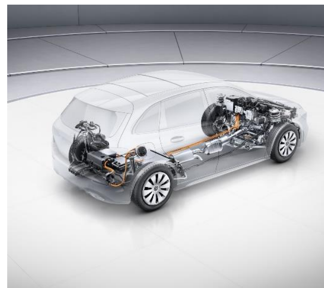
Radar για ανάκτηση ενέργειας Διαχείριση της ενέργειας από την επιβράδυνση του οχήματος με αποθήκευση στη μπαταρία του οχήματος
