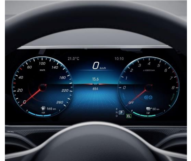
Προγράμματα Οδήγησης Comfort, ECO, Individual, Sport, Electric και Battery Level. Στο πρόγραμμα Electric το όχημα κινείται αμιγώς ηλεκτρικά με μέγιστη τελική ταχύτητα 140 km.
