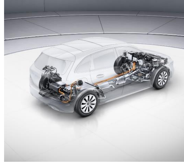
Radar για ανάκτηση ενέργειας. Διαχείριση της ενέργειας από την επιβράδυνση του οχήματος με αποθήκευση στη μπαταρία του οχήματος
